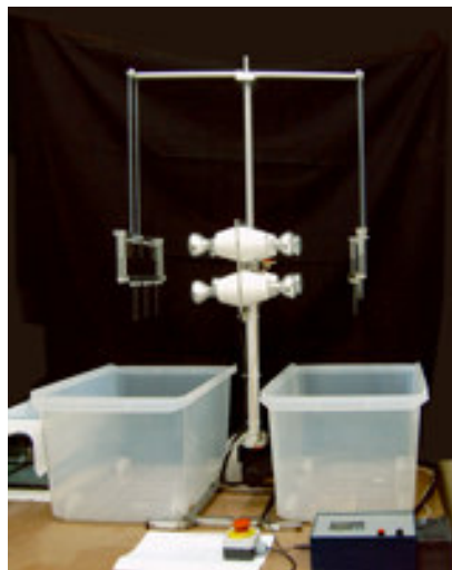
Fig. 8.1. Robot automatizado que realiza los ensayos de corrosión.
