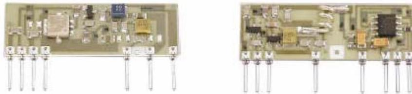
*Figura 7.4.- Módulos transmisor TX-SAW (izquierda) y receptor BC-NBK (derecha) de la marca AUREL*
