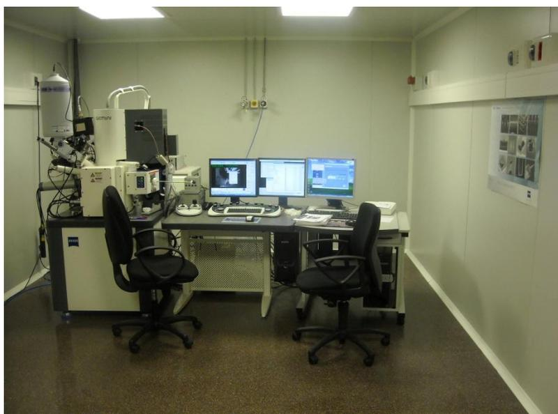
*Figura 5.23: Microscopio electrónico de barrido (CRnE)*
