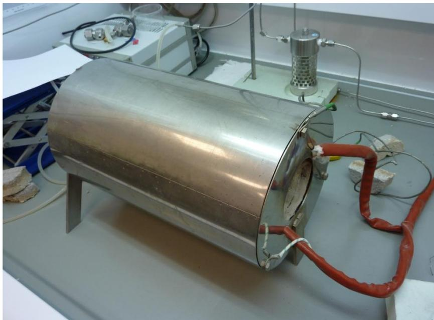
*Figura 6.8: Horno utilizado para aportar el flujo térmico necesario al reactor*
