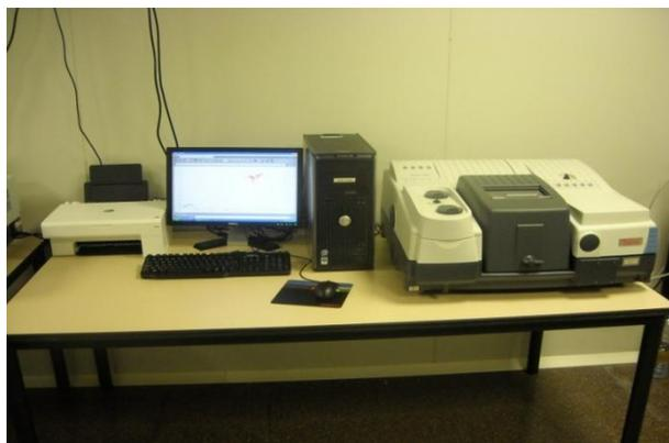
*Figura 5.24: Espectrofotómetro IR (CRnE)*
