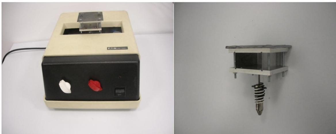
*Figura 5.27: Aparato para ensayos vibracionales*
