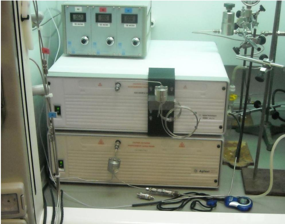
*Figura 6.7: Micro cromatógrafo de gases*
