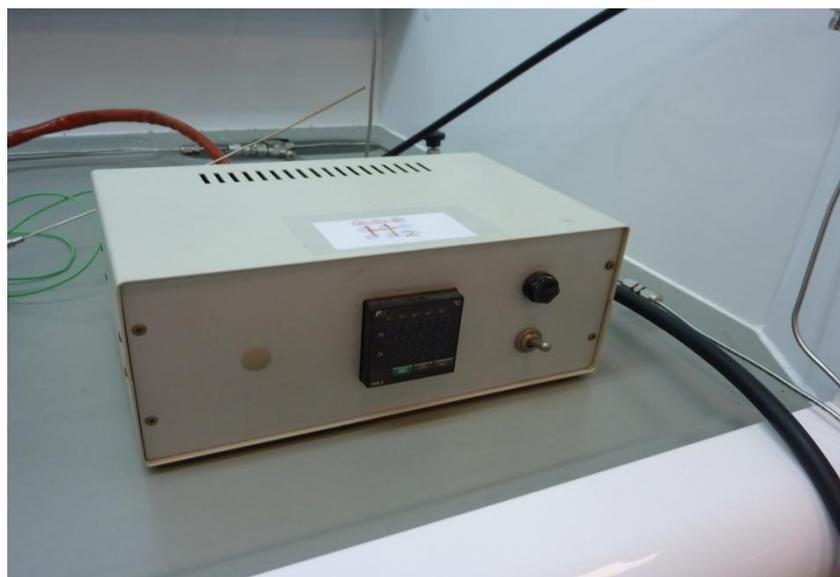
*Figura 6.9: Controlador del horno*
