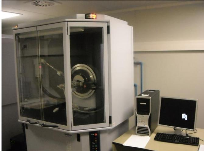
Figura 5.1: Aparato para difracción de rayos X (CRnE)
