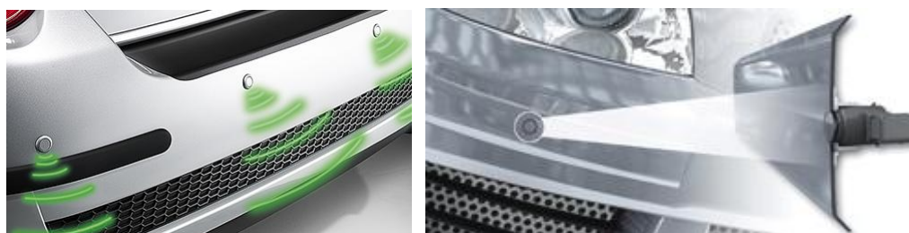
Figura 3.7. Sistema d'assistència a l'estacionament amb sensors d'ultrasons
