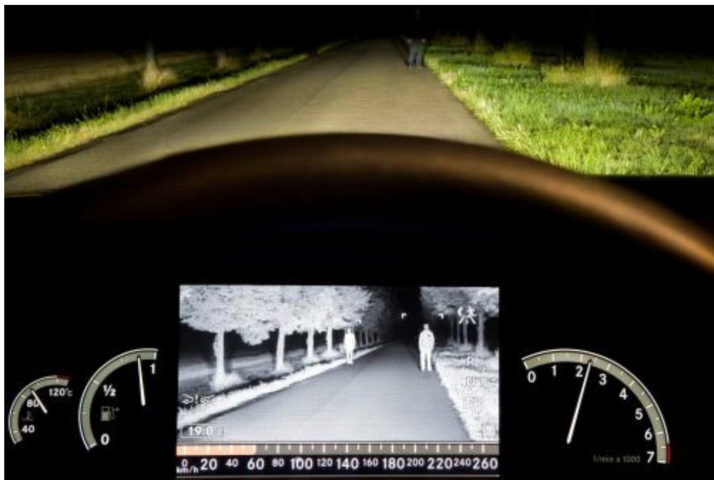
Figura 3.6. Sistema de visió nocturna amb fars infraroigs
