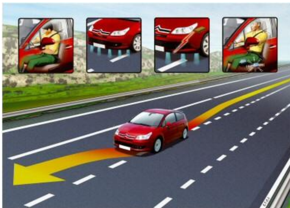
Figura 3.8. Sistema d'alerta al canvi involuntari de carril amb infrarojos
