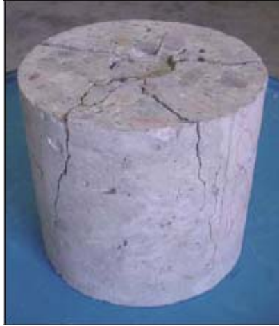
Figura 2.6 Proveta de formigó un cop realitzat l'assaig Barcelona
