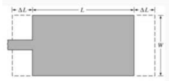
Figura 27. Longitud efectiva y física de la antena tipo parche. (Balanis)
