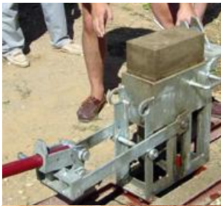
Figura 4.2.2.2. Realització d'un bloc de BTC. FONT: Associació Terra Chidia, www.tierrachidia.es
