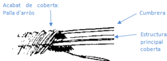
Figura 3.1.15. Detall del cosit d'una cumbrera de tipus "cosida".
