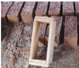
Figura 4.2.2.1. Acopi de blocs posterior a l'assecat dels mateixos. FONT: Institut Jane Goodall (IJG), Departament de Bio Construcció, Senegal.
