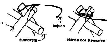
Figura 3.1.9. Detall de la fixació de la cumbrera en el cas de les cobertes a dues o quatre aigües.
