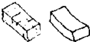
Figura 3.2.2.4. Esquema dels resultats després del procés d'assecat
