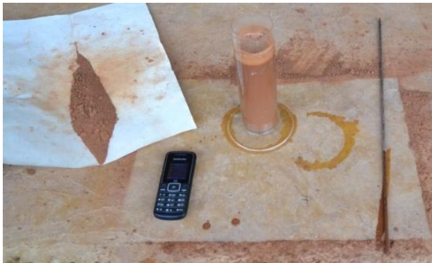
Figura 3.1.1.2. Prova d'estratificació del sòl.
