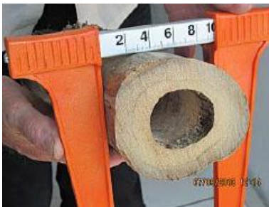
Figura 3.1.1.1. Medició del diàmetre d'una canya de bambú africà
