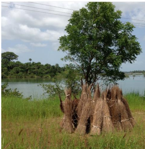
Figura 3.2.2.7. Feixos de palla d'arròs durant el procés d'assecat. Llestos per a la seva col·locació a la coberta.
