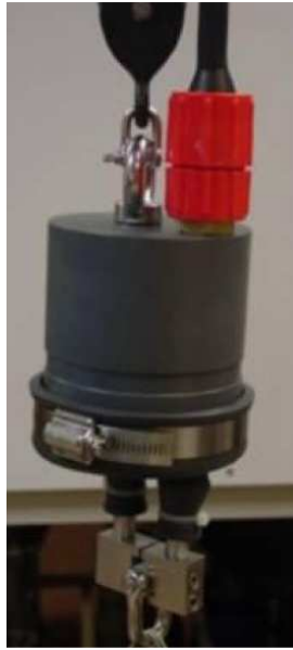
figura 1.4 Alliberador mecànic “ deepsea release unit ” de GURALP SYSTEMS
