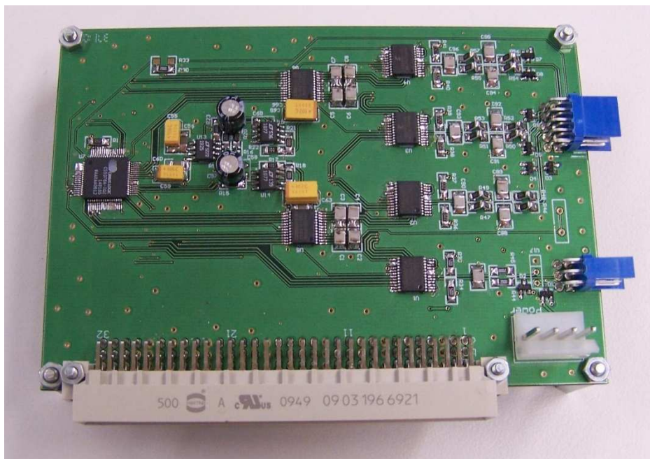
figura 2.16 Mòdul d'adquisició de dades i convertidor d'analògic a digital
