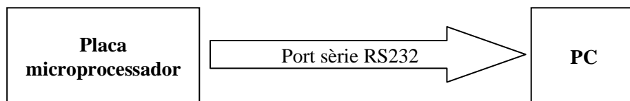
figura 5.2 Esquema de la connexió per la prova del port sèrie
