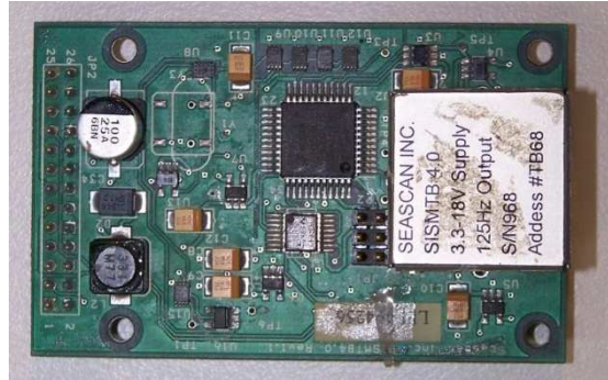
figura 2.9 Placa seascan generadora de rellotge
