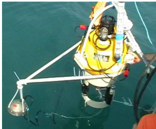
figura 1.6 Estructura MiniDOBS i electrònica UPC-SARTI
