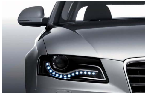
Figura 3.6-7 Luminàries LED en un vehicle AUDI
