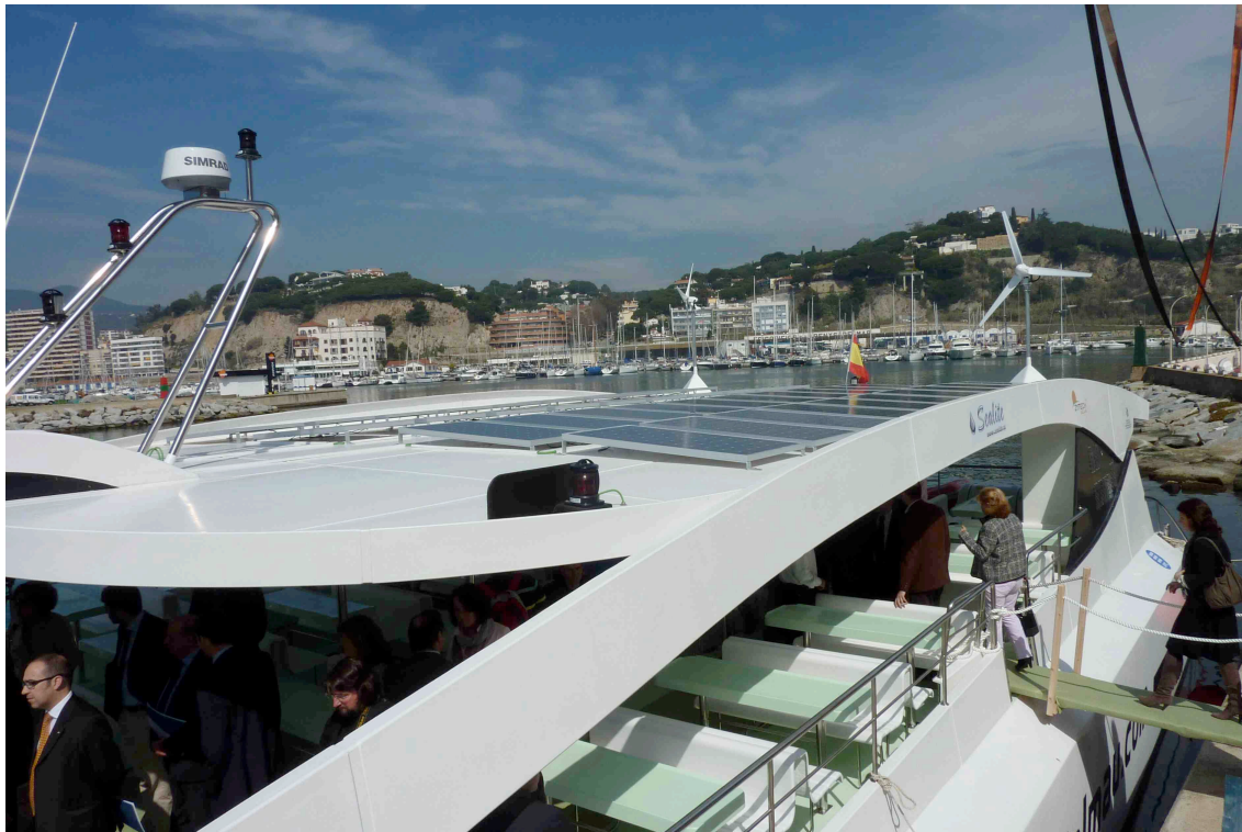
Figura 7.26: Disposició panells solars de l'embarcació Eco Slim. Font: Drassanes Dalmau
