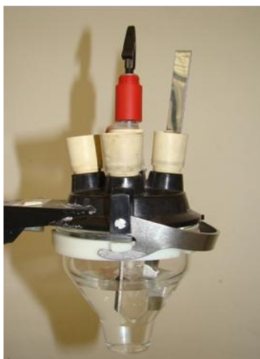
Fig. 7.11. Fotografía de la celda electroquímica utilizada sin conectar a la fuente externa de energía eléctrica.
