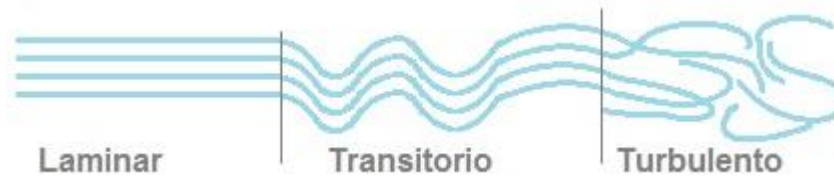
Figura II.3. Transición del flujo de laminar a turbulento
