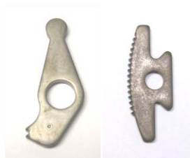
Figura 3.5 Exemple de trinquet i serreta actualment utilitzat
