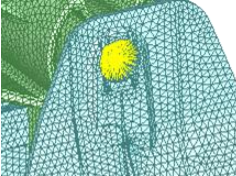
Figura 5. 1 Vista detall dels elements rígids introduïts a zona de rotació entre base i braç
