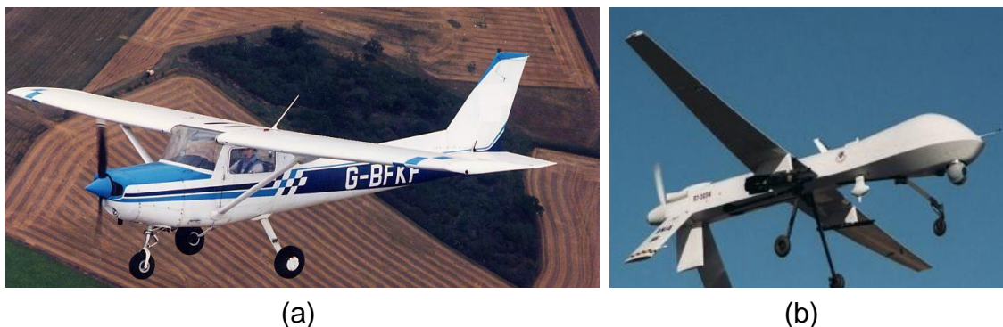
Fig. 2.3 Aerodinos de ala fija: (a) Aeronave [13], (b) RPA de ala fija [14]
