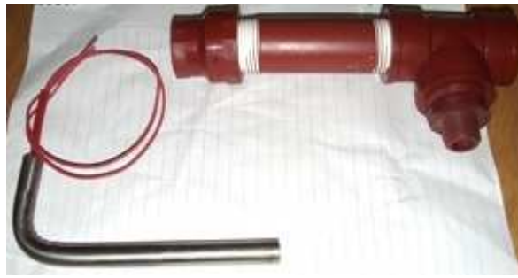
Figura 3. Resistencia eléctrica, cañería y accesorios de polipropileno del caudalímetro.
