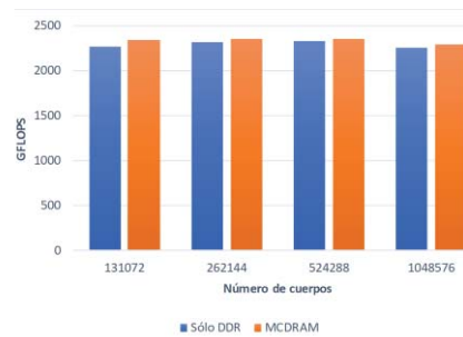
Fig. 7. Rendimientos obtenidos para la explotación de MCDRAM al variar la carga de trabajo ( N ).
