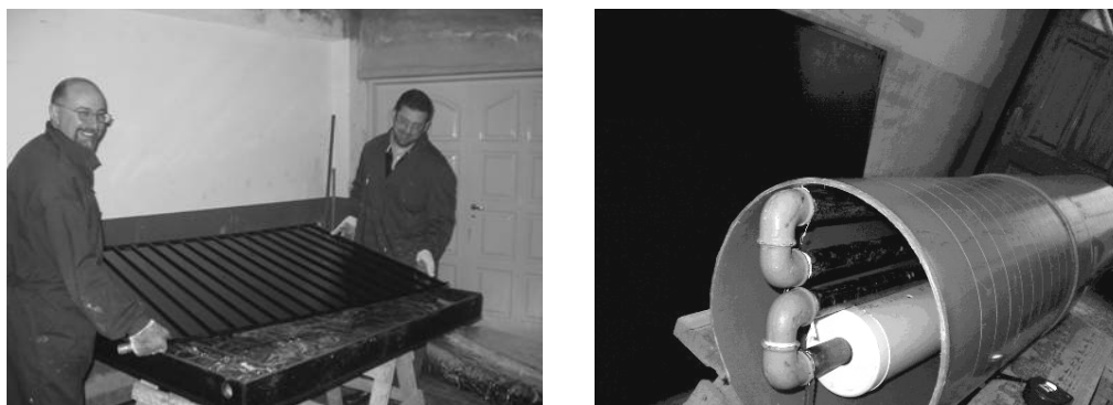
Figura 4 (izq.) Placa colectora y carcasa con aislamiento, y (der.) vista del intercambiador dentro del depósito
