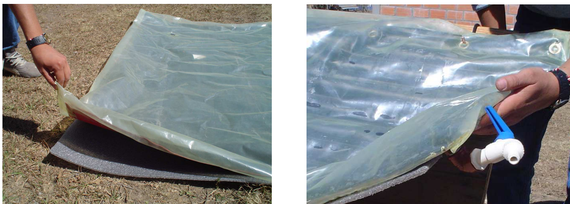
Figura 3: Vistas del aislante inferior de polietileno expandido y de la cubierta transparente de plástico de invernadero.
