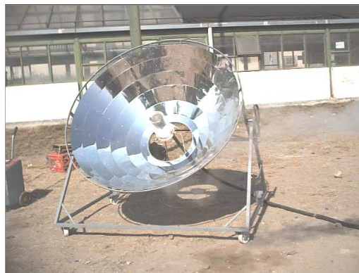
Fig.2. Vista de frente del concentrador parabólico con la caldera en el foco
