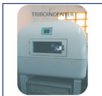
Figura 3: Nanodurómetro del Laboratorio de superficies Facultad de Ingeniería (INTEMA - CONICET - UNMDP)
