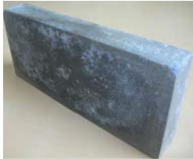
Figura 9 – Fotografía de los áridos vitrificados derivados de una planta de gasificación por plasma de RSU
