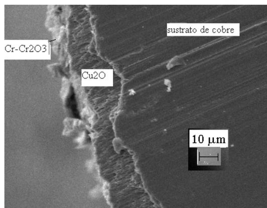
Fig.1 Micrografía del corte transversal de una multicapa Cr-Cr<sub>2</sub>O<sub>3</sub> / Cu<sub>2</sub>O sobre cobre. Magnificación 400X.
