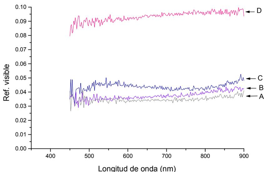
Fig.5 Reflectancias espectrales en el visible de superficies con Cr-Cr<sub>2</sub>O<sub>3</sub> envejecidas térmicamente durante una semana en aire. A: muestra de control, B: a 200°C, C: a 300°C, D: a 400°C.
