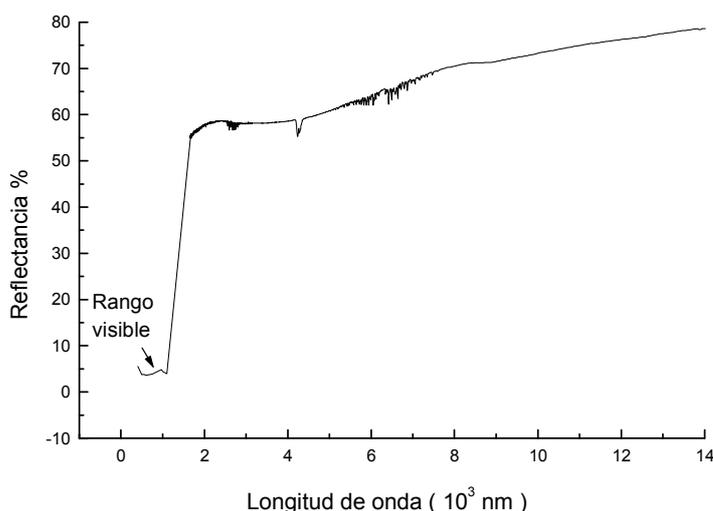
Fig 2 Espectro de reflectancia visible e infrarroja de una superficie recubierta con Cr-Cr<sub>2</sub>O<sub>3</sub> mediante el método desarrollado.
