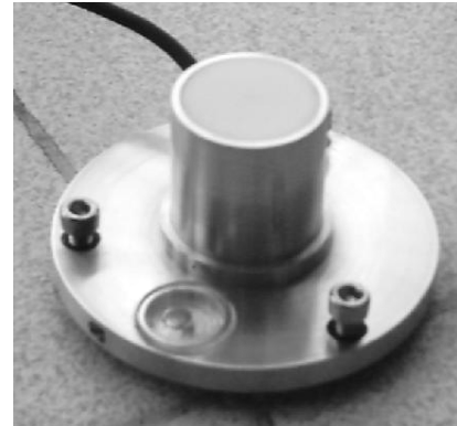
Figura 2.- Foto del Piranómetro fotovoltaico construido.
