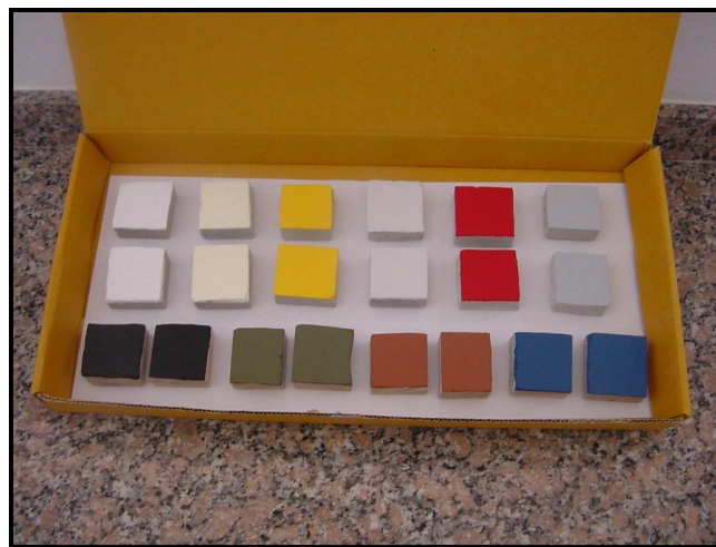
Figura 6. Probetas utilizadas para determinar la absorbancia solar a través de mediciones espectrofotométricas.
