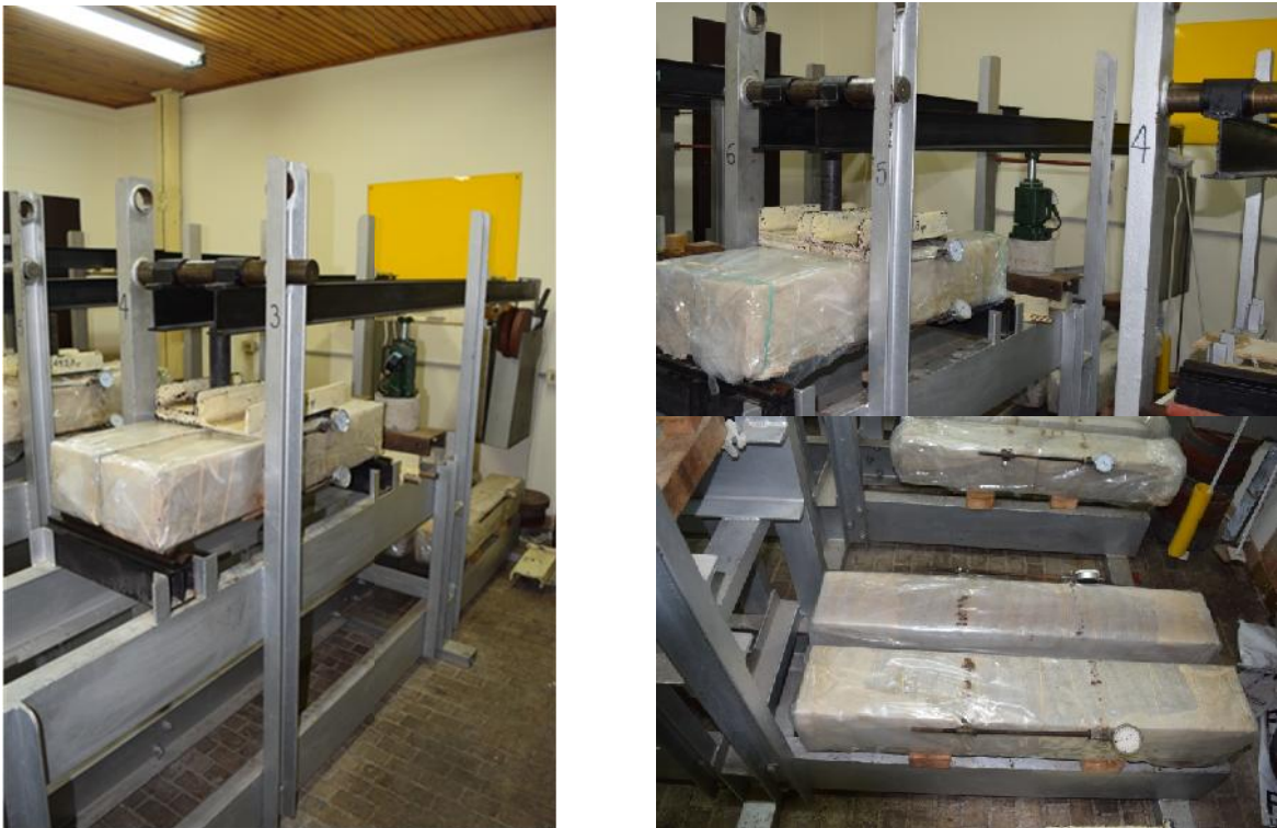
Figura 2: Montaje de las vigas de hormigón armado en los pórticos, vigas de referencia sin cargar.
