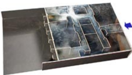
Fig 5 Ensayo en Túnel de Viento. Dirección del flujo De aire perpendicular a la fachada.
