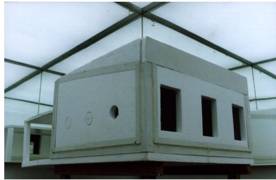
Figura 3: Mediciones en cielo Artificial
