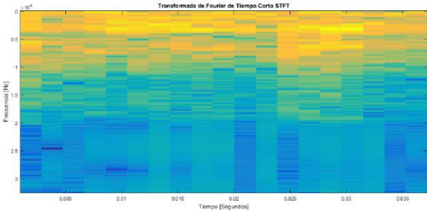
Figura 7. Caracterización de la señal de vibración utilizando STFT, la señal de vibración se dividió 10 veces, es decir, un total de 19 ventanas de análisis.
