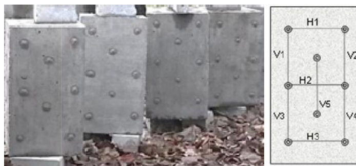
Figura 1: Vista de los bloques de hormigón y esquema de las mediciones de deformación.
