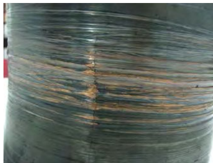
Figura 7: Cilindro conformado, se observan "surcos" de deformación altamente localizada sin lograrse la reducción de diámetro buscado. Producto de esta situación se genera el defecto observado.
