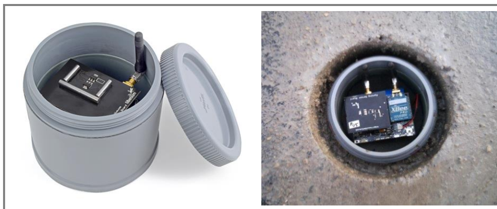
Fig. 41 - Nodos sensores en el pavimento para Smart Parking [109]
