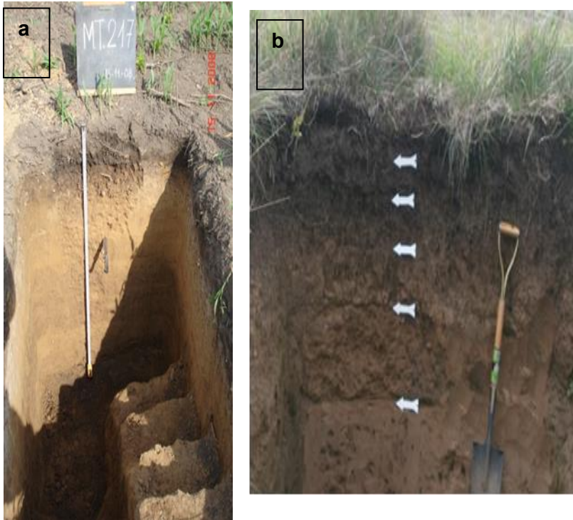
Figura 5: a) Calicata; b) Horizontes de un perfil del suelo
