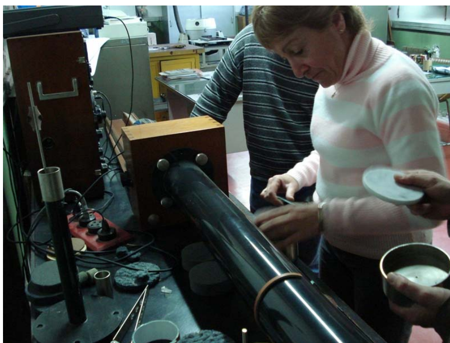
Figura 7. Medición con tubo de Kundt de las alfombras de paraíso.
