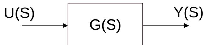
**Figura 1.** La planta se representa como  $G(s)$ , en términos de la Transformada de Laplace. La salida,  $Y(s)$ , al igual que la entrada  $U(s)$ , se representan mediante la Transformada de Laplace.
