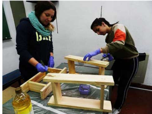
Fig. 4 y 5. Armado de moldes (Fuente: Obtención propia)
