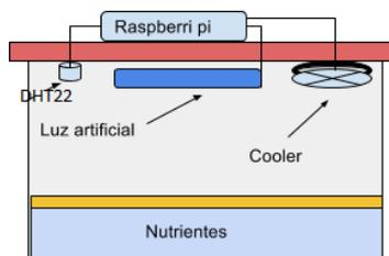
**Figura 2.** Diagrama de la cámara de germinación.
