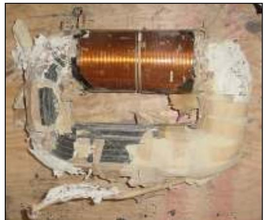
Foto 2 – Circuito magnético de un transformador de medición
