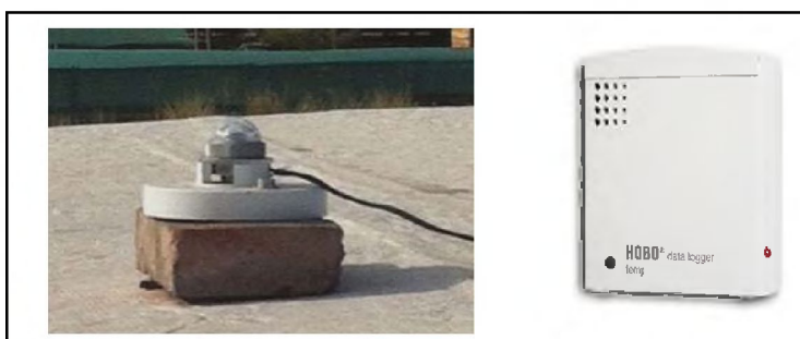
Figura IV.12. Solarímetro Kipp & Zonen y sensor de temperatura y humedad Hobo U12
