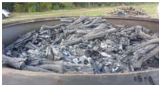
Normalmente, la duración del proceso abarca de 3 a 5 días, dependiendo de la marcha de la carbonización, nivel de vientos de la zona, condiciones climáticas, experiencia del operario, etc. El horno metálico transportable suele necesitar un escaso mantenimiento (se aconseja guardarlo bajo techo mientras no está en uso para evitar corrosión oxidativa), y su vida útil alcanza unos 10 años utilizándolo en forma continua.
