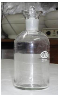
**Figura 2.7.** Botella de DBO de vidrio (250 ml) con cierre hidráulico.
