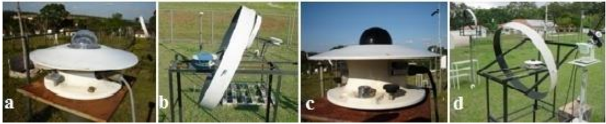
Figura 2. a) Piranômetro medindo a global total; b) Piranômetro com anel de sombreamento medindo a difusa; c) Piranômetro medindo a IV, e d) Piranômetro com anel de sombreamento medindo a difusa infravermelho.
