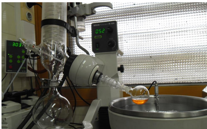
Figura A2) Concentración en evaporador rotatorio de la tintura de ají picante.
