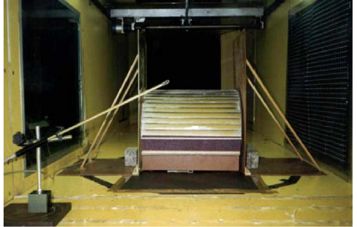
Ensayo de cargas aerodinámicas sobre parasoles. Edificio Museo de la Fundación Fortabat
