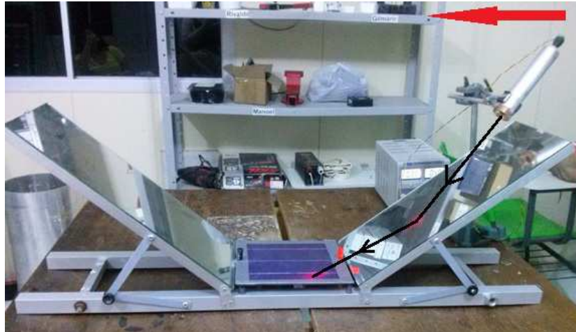
Figura 3 – Determinação experimental da função de aceitação angular.
