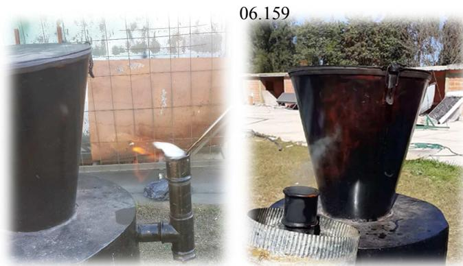
Figura 10: Generación de syngas evidenciada por la llama: Ensayo con briquetas (izq.); y con pino (der.)
