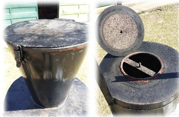
Figura 2: Detalle tobera, tapa y burletes en parte superior del gasificador (izq.); detalle tapa y burletes en parte inferior (der.).
