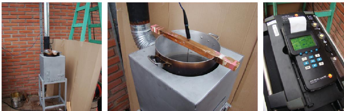
Figura 2. Ensayo de emisiones siguiendo el protocolo WBT. Vista general (izquierda), colocación del termómetro en el interior de la olla (medio) y equipo utilizado para el registro de datos (derecha).
