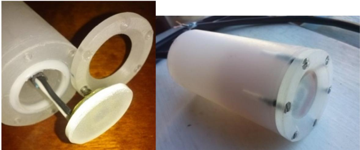
*Figura 5. Imágenes del radiómetro en proceso de armado (izquierda) y terminado (derecha).*
