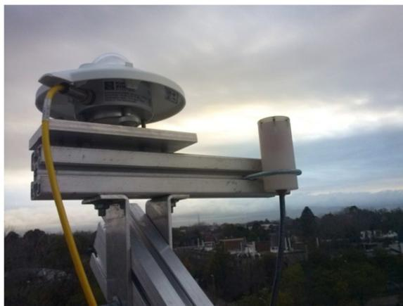
*Figura 6. Imagen del Radiómetro acuático montado en aire para su contrastación con Solarímetro CMP6 de Kipp & Zonen.*
