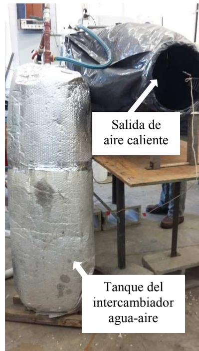
Figura 3 b) Intercambiador agua-aire ensayado
