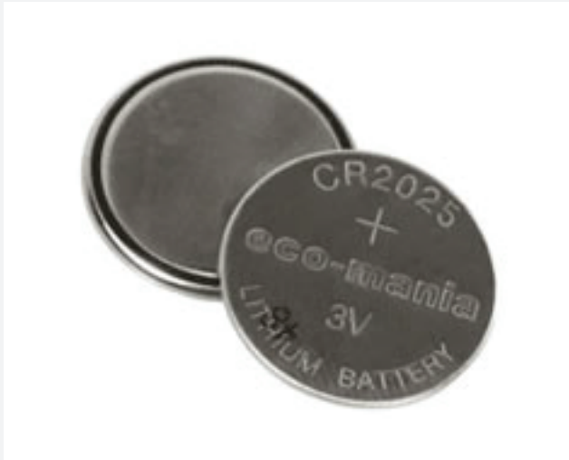
Pila o batería de 3V necesaria para manter encendido el Led (Fig 4).
