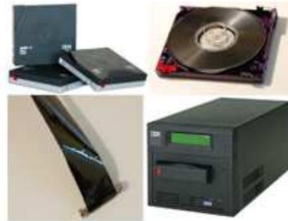
**Figura 9. Ejemplo LTO (Linear Tape-Open).**
