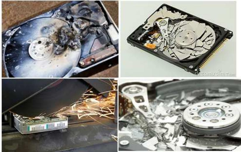
**Figura 16. Ejemplos de discos destruidos con métodos de destrucción física.**
