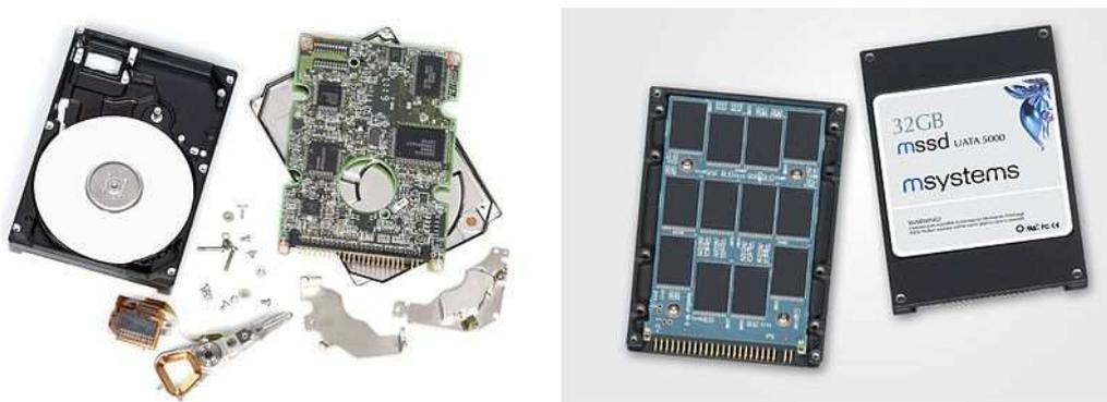
Figura 7. Disco Duro vs SSD, composición interna.
